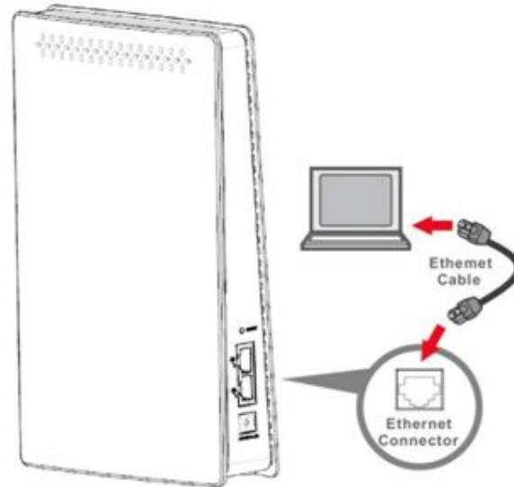
Figura 3 - Instalando o cabo de rede (caso tenha necessidade)
